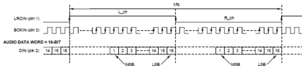
Fig. 2.8: Temporizzazione "Normal" dei Dati in ingresso al PCM1725.
